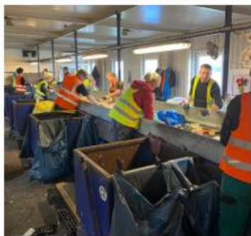
Dotříd'ovací linka na plasty – pás s odpadními plasty určenými ke třídění
