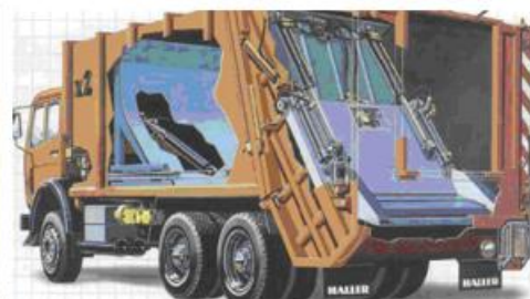
Svozová technika – systém stlačování odpadu
