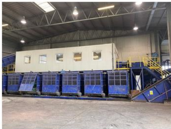
Dotříd'ovací linka na plasty – boxy na tříděný plast
