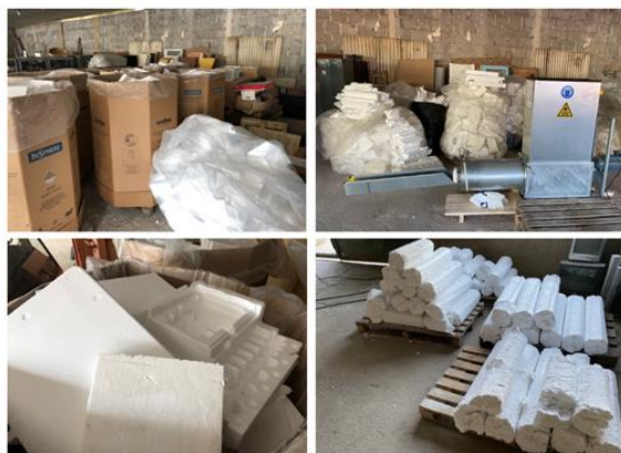
Třídění a kompaktování odpadního EPS
