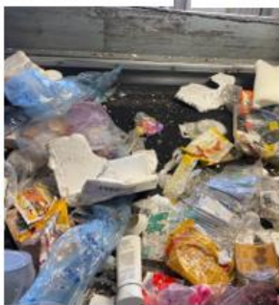
Dotříd'ovací linka na plasty – pás s odpadními plasty určenými ke třídění
