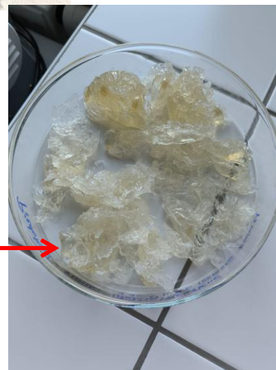
Obr : Reakce AmimCl a viskózy Vzniklý gel
