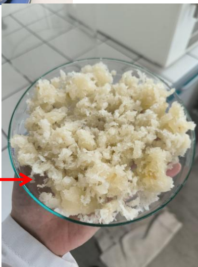
Obr : Reakce EmimCl a viskózy Vzniklý gel
