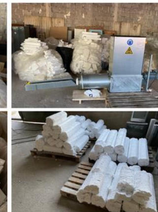
Třídění a kompaktování odpadního EPS
